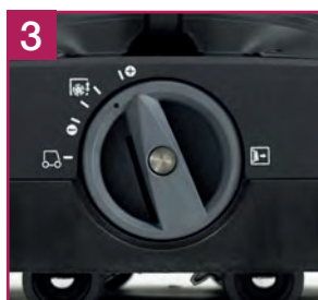
3. Nastavte kartáče na vysoký tlak stroje.
